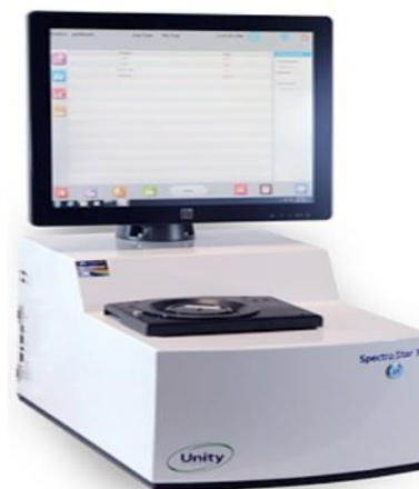
Strumento NIR da banco Strumento NIR SpectraStar XT1 –UNITY 2600, fornito dalla Hellma
