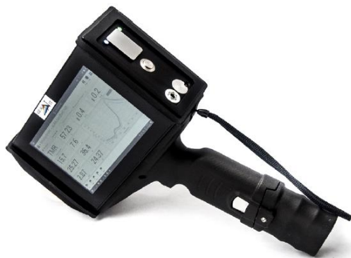
Strumento NIR portatile modello Aurora Granit, fornito dalla Hellma
